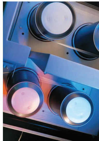
Beheizte Streckrollenaggregate zum Verstrecken von Filamentgarn
