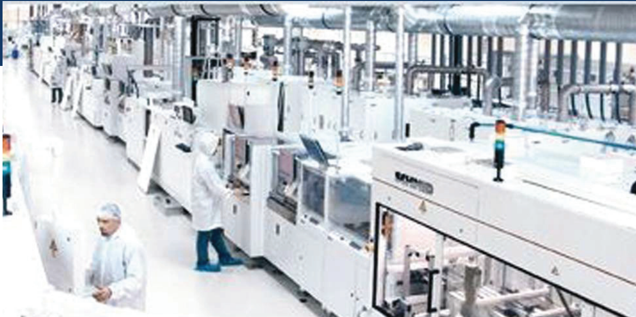
Ansicht einer SCHMID-Anlage zur Solarzellenfertigung
