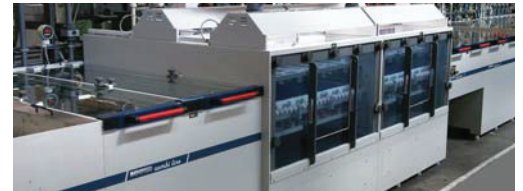
Schmid Resisttechnologie für Leiterplatten DES (Linie Entwickeln-Ätzen-Strippen) Beispiel für eine Anlage im Bereich der Leiterplattenproduktionsanlagen im Modulsystem Combi-Line
