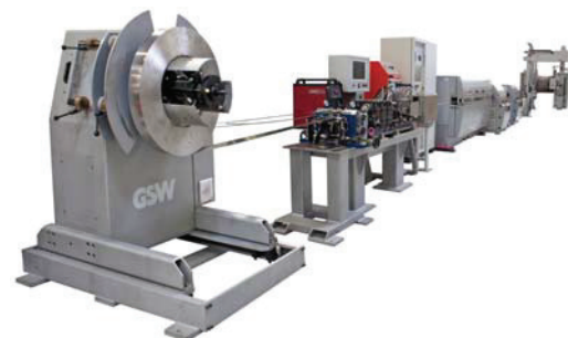
Produktionslinie TS-W für die Erzeugung von Solarrohren
