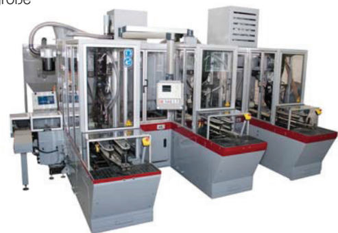
Batteriemaschine BMW 10 zum Eintaschen von Autobatterien
