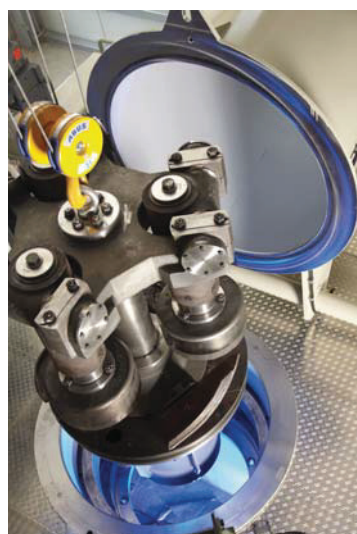
Innovation: der Direktantrieb der PM-Pendelmöhle
