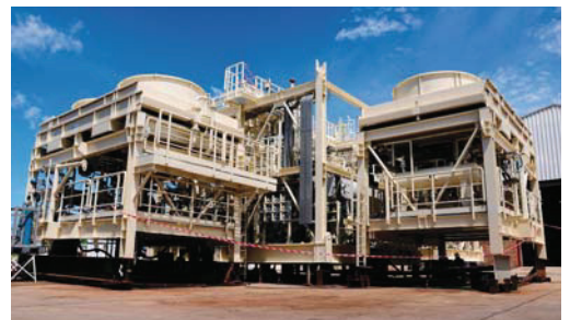
Zweistöckige Verdichteranlagen für den Offshore-Einsatz zur Rückführung von Fackelgas
