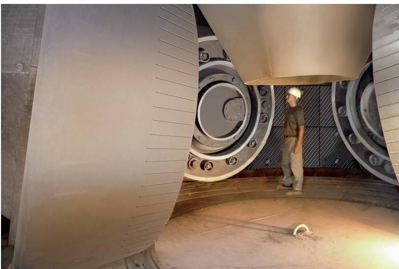
Innenansicht einer LOESCHE-Mühle Typ LM 60.4 mit 4 Walzen
