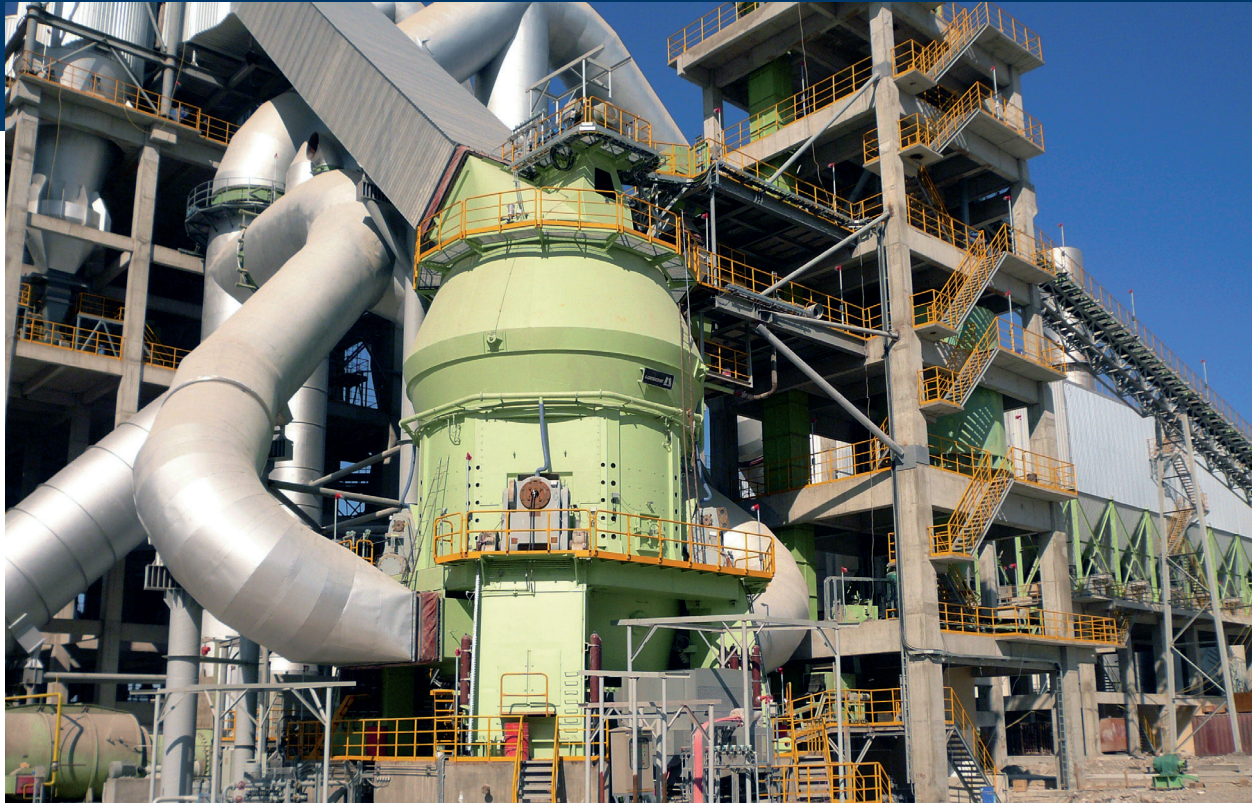
LOESCHE-Mühle, Typ LM 60.4, zur Vermahlung von Rohmaterialien
