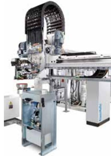
Manipulator einer Reaktionstechnikanlage
