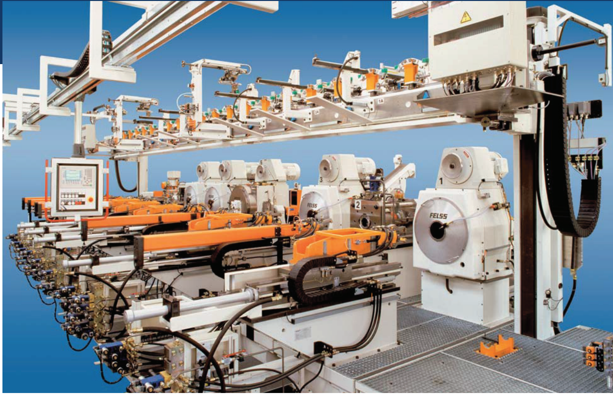
Ansicht einer 10-stufigen, vollautomatischen Rundknet-Transferanlage Typ HA 40-10 VUE
