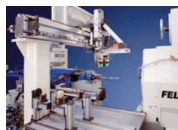
Spanlose Umformung und Fertigteilherstellung durch Rundkneten
