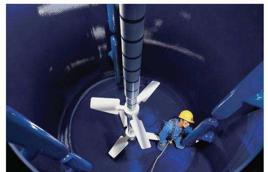
Reaktor mit doppeltem Rührwerk, vollerniillierte Oberflächen
