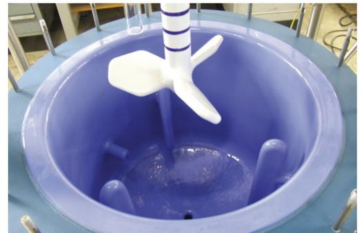
Reaktor mit Rührwerk
