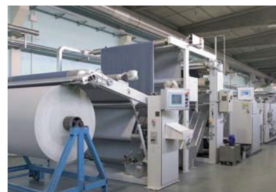
BRÜCKNER Spannmaschine POWER-FRAME: Auslauf Großdockenwickler mit Umfangsantrieb, Changierwalze und vorgeschalteter Warenspeichermulde
