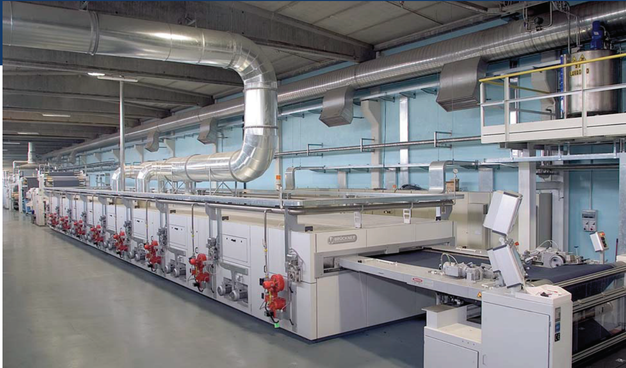
BRÜCKNER Spannmaschine POWER-FRAME mit patentiertem split-flow Belüftungssystem
