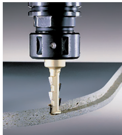
Kantenbearbeitung durch Fräsen
